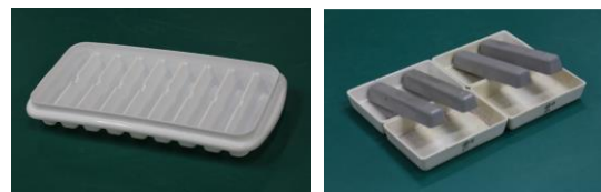
図-3 棒状ペースト供試体用の型枠と加熱前の様子
