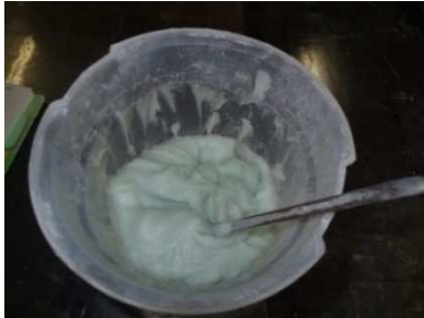
写真-1 混合後の防錆剤混入ゲルの様子
