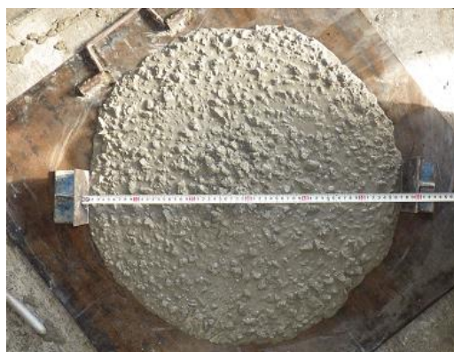
写真—1 混合物のスランプフロー
