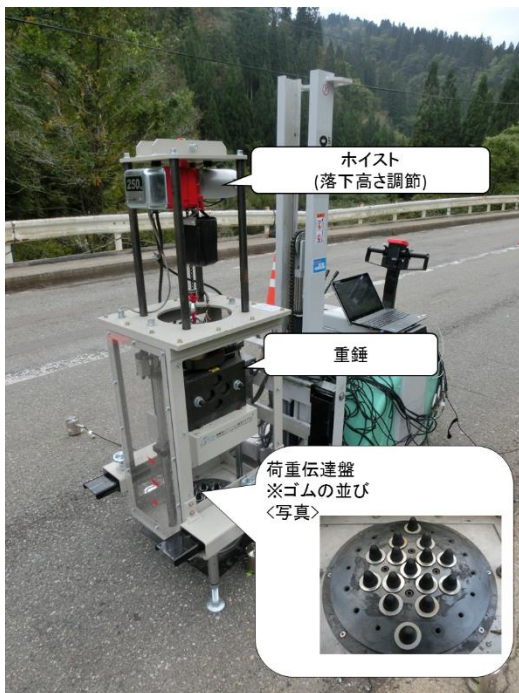
写真-3 自走式衝撃加振装置 SIVE
