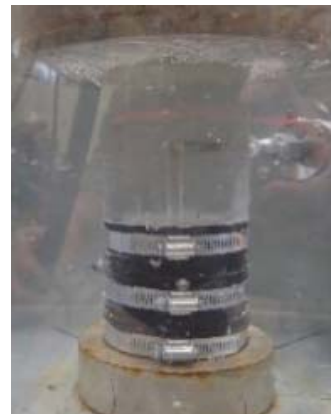
(b) 水槽内における供試体の設置状況
