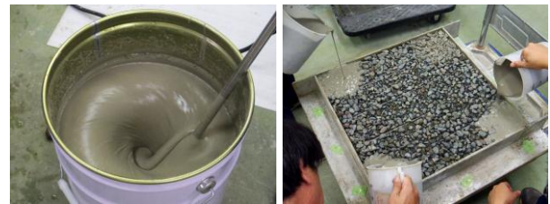
(a) グラウト材の混練 (b) グラウト材の注入
