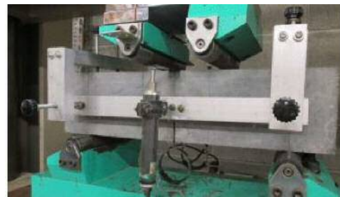
写真-4 切り欠き梁の 3 等分点曲げ試験状況
