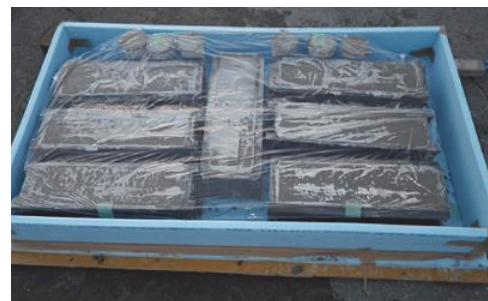
写真-2 断熱材容器を使用した保温養生の状況
