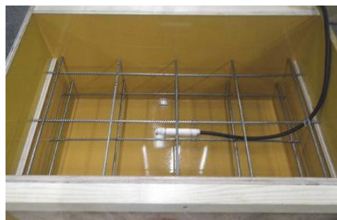
写真-3 舗装版を模擬した収縮ひずみ測定用型枠
