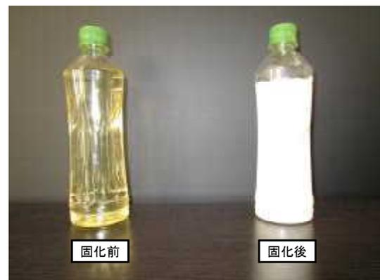
写真-1 固化したNS水溶液(4.0mol/L)
