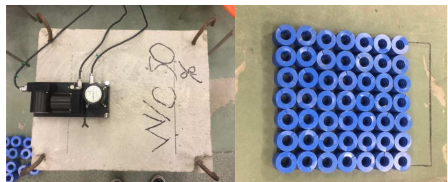
図-6 供試体計測状況(左)と圧縮ばねの配置(右)
