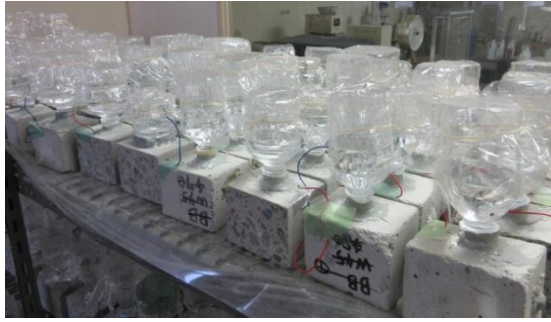
写真-1 鋼材腐食促進試験の状況
