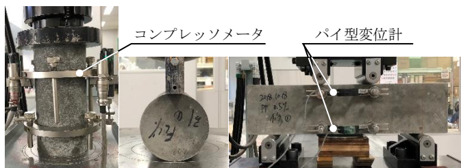
図-2 各強度試験時の画像 (圧縮・割裂引張・曲げ)
