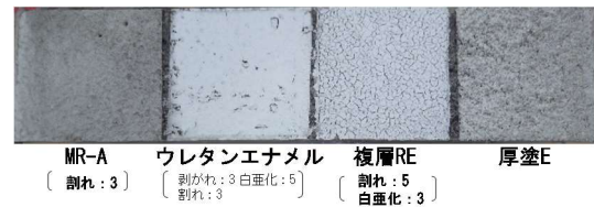
図-4 試験体写真の例 (B13, 暴露 30 年目)
