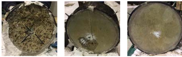
a) HSC_2 b) HSC+PP_2 c) HSC+Jute_2 図-5 材齢 2 ヶ月における加熱面の状況 11)
