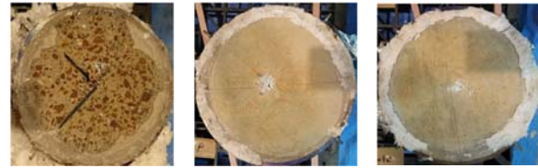
a) HSC_14 b) HSC+PP_14 c) HSC+Jute_14 図-6 材齢 14 ヶ月における加熱面の状況
