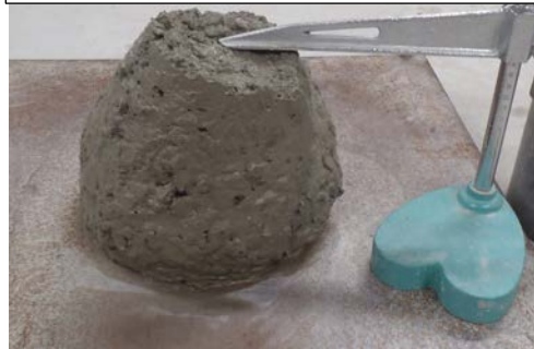
図-6 気泡増加量が相違するコンクリート性状
