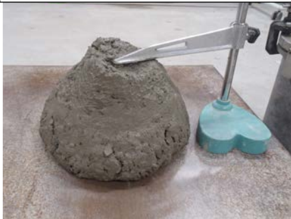
図-6 気泡増加量が相違するコンクリート性状
