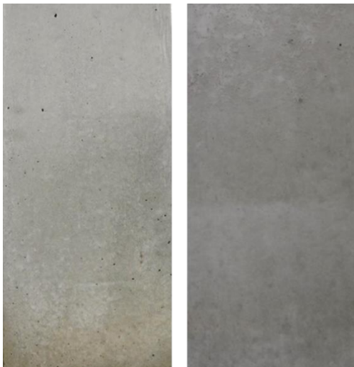
図-6 コンクリート硬化体表面美観性の比較 (左:コンクリート硬化体 a, 右:コンクリート硬化体 o)
