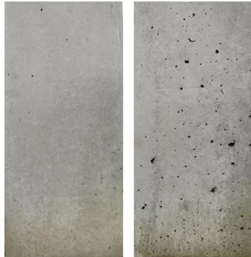
図-4 コンクリート硬化体表面美観性の比較 (左:コンクリート硬化体 a, 右:コンクリート硬化体 b)
