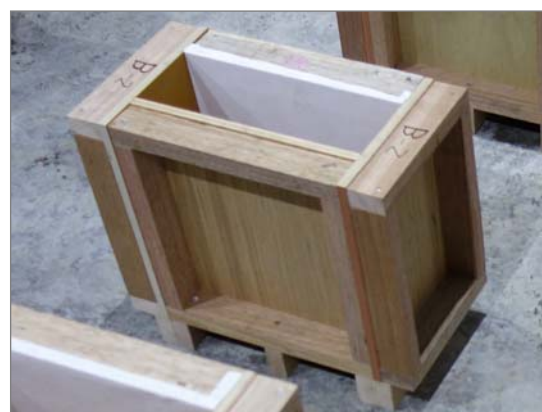
写真-1 型枠（奥側の型枠材に不織布張付け）
