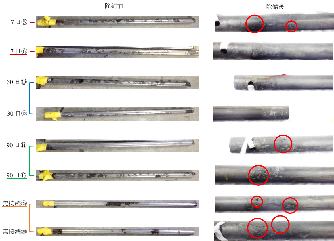
写真-1 鉄筋の腐食状況 (暴露後約 180 日, 赤丸は孔食を示す)
