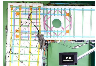
(c) 実験終了時 ( R=40 \times 10^{-3} rad 経験後) 写真 - 1 LJO10 試験体 破壊状況
