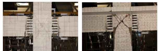
(a) 試験体 PCJ08 (b) 試験体 PCJ09 写真 1 実験終了後試験体の破壊性状
