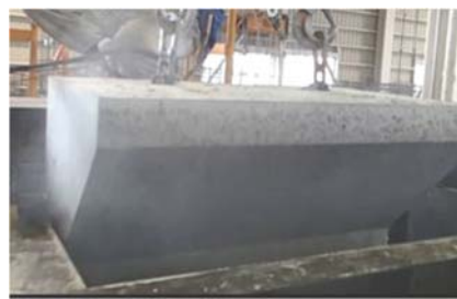
写真-1 試験体の脱型（冬-シート無）
