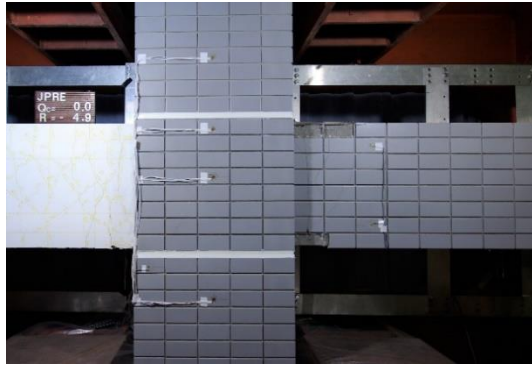
(a) JPPE (先付工法) 試験体
