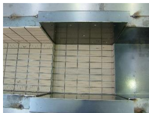
(a) PCa 型枠製作状況
