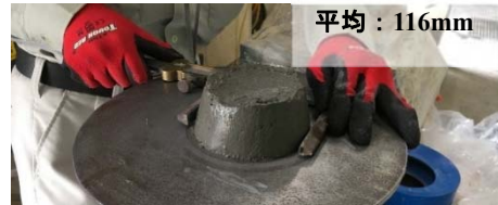
写真-2 UHPFRC のフロー試験 (0 打フロー)
