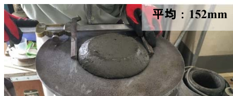
写真-3 UHPFRC のフロー試験 (15 打フロー)
