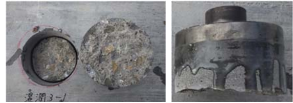
写真-7 直接引張試験状況(部材破壊)
