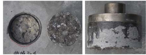
写真-6 直接引張試験状況(界面破壊)
