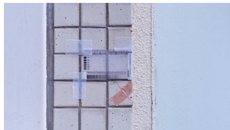
写真-4 ひび割れ幅の評価の様子 (1 階の柱, X 位置, 撮影距離 5m, 1 億画素カメラ)
