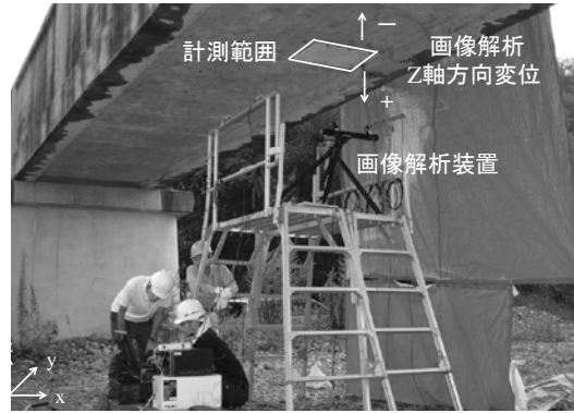
図-2 コンクリート水路橋・底版部計測概要 (x, y, z : 画像解析における軸方向)
