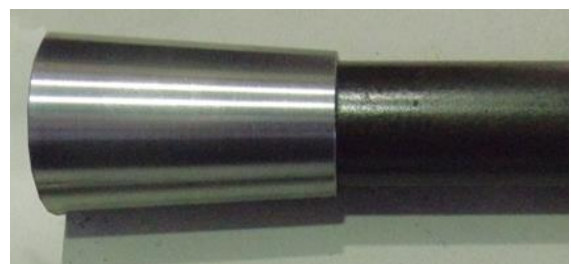
写真-2 テーパ型先端定着体を PC 鋼棒にセットした状態
