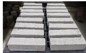
写真-1 曝露試験の状況
