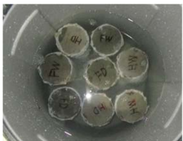
写真-4 塩水浸漬状況
