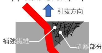
(f) 45°試験体の表面剥離(拡大図)
