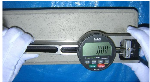
写真-1 基準標尺による 0 設定
