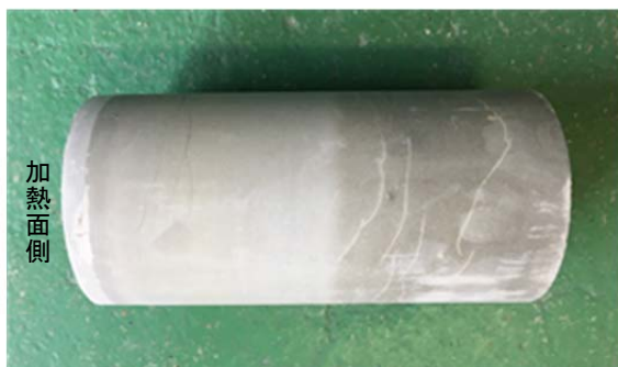
写真-3 加熱後の試験体の外観
