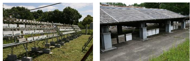
写真-1 屋外暴露試験の様子 (左: 屋外雨あり, 右: 屋外雨なし)
