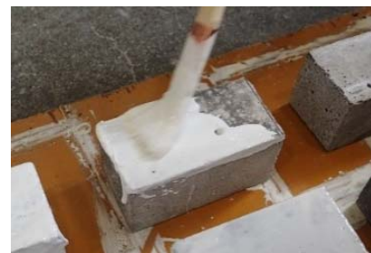
写真-2 エポキシ樹脂塗布の様子
