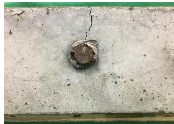
図-14 鉄筋D供試体写真
