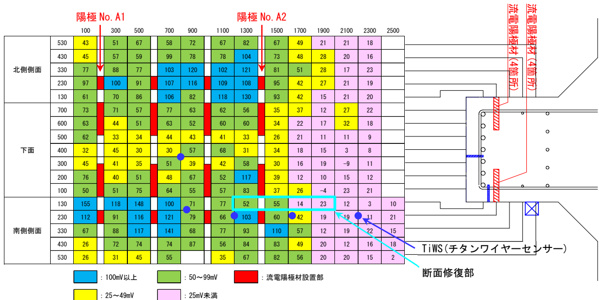
図-9 可搬式SSEを用いて計測した復極量(mV)の分布(通電直後)
