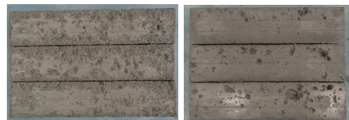
(i) 標準 (ii) 改善 写真-8 供試体の状態 (324 サイクル時点)
