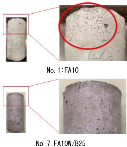
図-5 水結合材比の違いによる供試体劣化状況 (硫酸浸漬期間 28 日)
