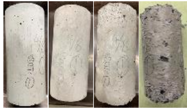
図-2 No.1 の硫酸浸漬試験供試体劣化状況 (左から硫酸浸漬期間 7 日, 28 日, 56 日)
