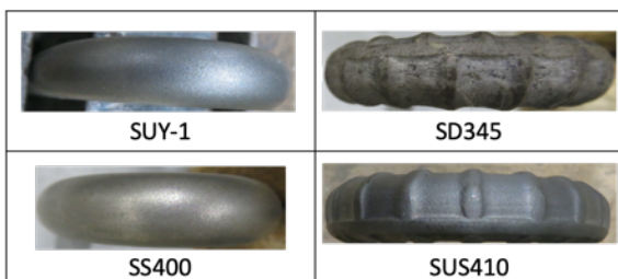
写真-1 試験片湾曲部の外側の様子
