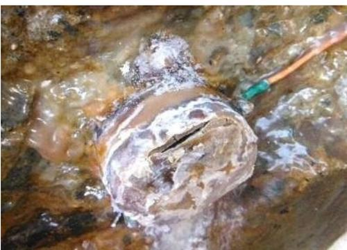
図-17 犠陽極上の防水塗膜破断
