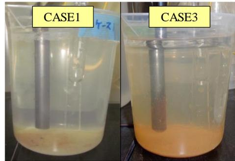
写真-1 CASE1 および CASE3 の腐食発生状況
