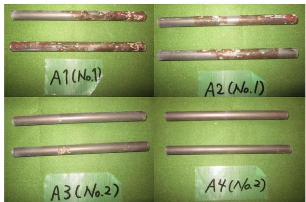
写真-2 鋼材の腐食状況
