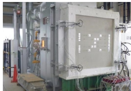
写真-3 耐火試験状況
