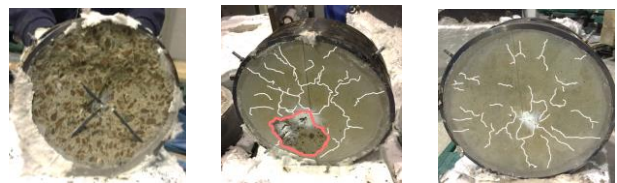
写真-2 リング拘束供試体加熱試験の爆裂状況 7)
