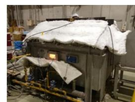
図-3 ガス水平炉
