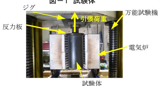
写真-1 試験装置と試験体設置状況
