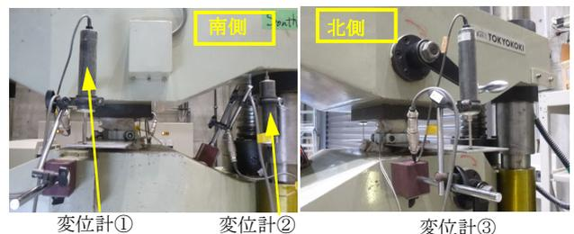
写真-3 油圧式万能試験機
