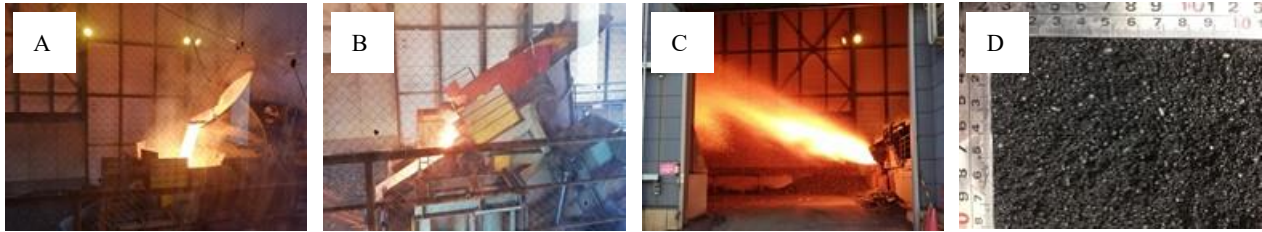
写真-1 EFSの製造状況および外観
