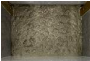
図-11 間隙通過後のフレッシュコンクリートの状態
