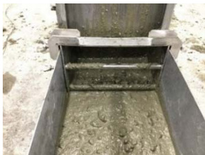
写真-1 Lスランブ試験 (SRF2-G2E, 障害有)
