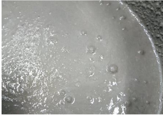
写真-4 モルタルから抜ける直前の気泡に膜ができている様子
