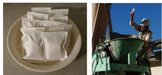
写真-2 水溶紙で梱包した流動化剤の外観と投入状況
