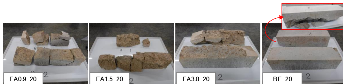
写真-2 実験ケース2の耐火試験後の試験体の状況
